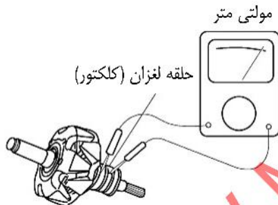
شکل ۳-۲۵: کنترل مدار بسته بین رینگ های روتور
