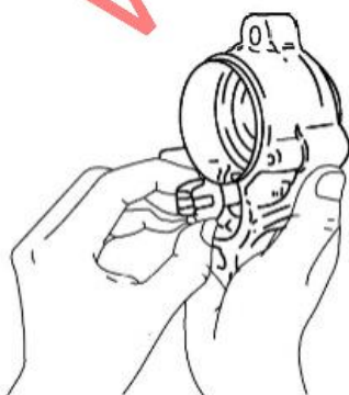
شکل ۲-۱۶: باز کردن بست
